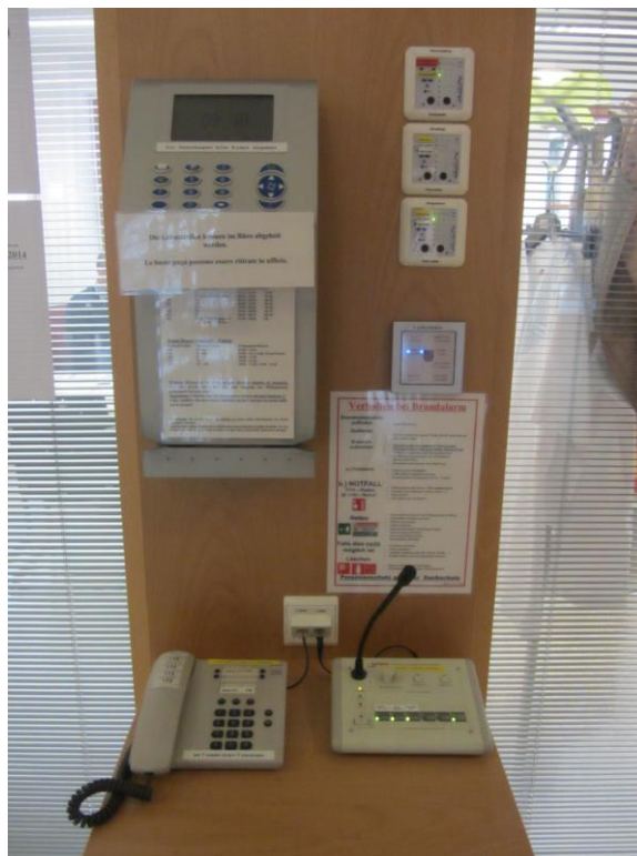
( Ablage mit Notruftelefon – daneben Mikrofon der Ausrufanlage)
